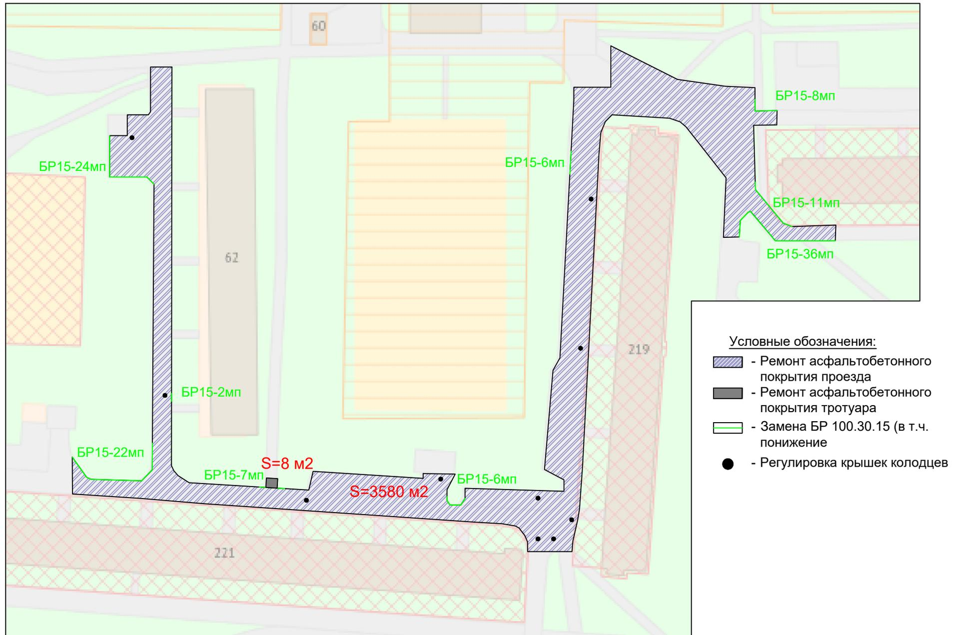
Схема ремонта асфальтового покрытия, расположенного на внутриквартальной территории.
