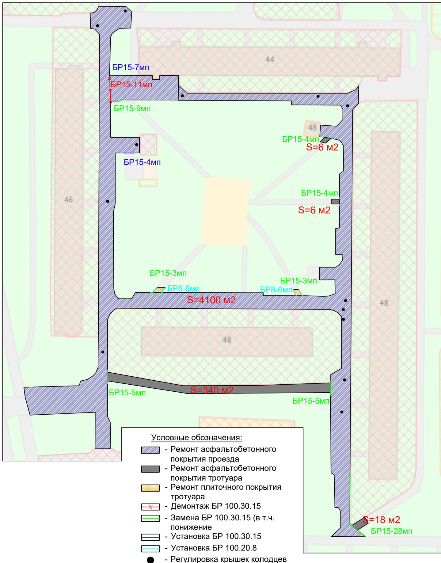
Схема ремонта асфальтового покрытия, расположенного на внутриквартальной территории.
